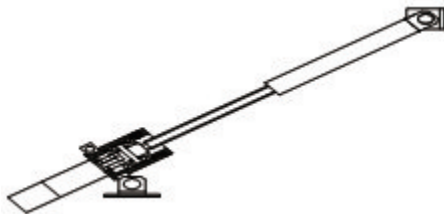
图8 主动力箱的斜拉机构
