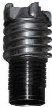
图11 2010年提出的取样钻头排屑槽结构 [10]
