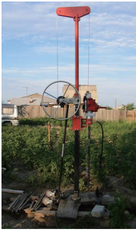
图1 加桅杆后的博地-10米钻机
