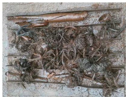
图2 捞取的钢丝绳及脱卡管碎片
