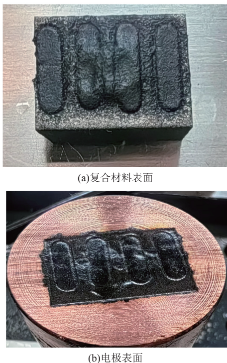
图12 电火花加工后聚晶金刚石复合材料表面与电极形貌
