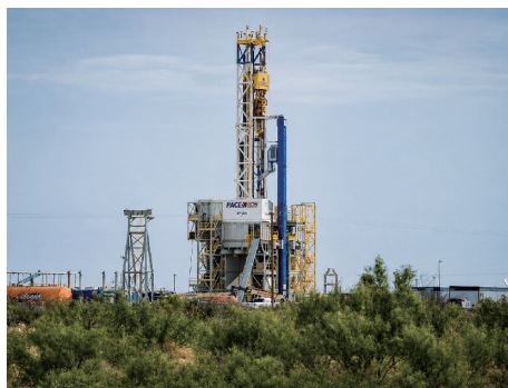
图3 PACE-R801型全自动陆地钻机 [29]
