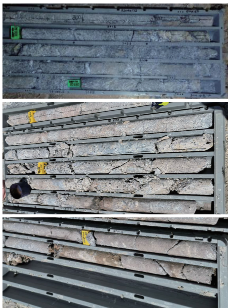
图8 半合管钻进工艺采取岩心照片
