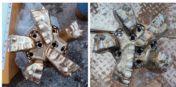
图7 五刀翼PDC钻头P1636S
