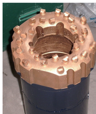
图8 PDC取心钻头示意
