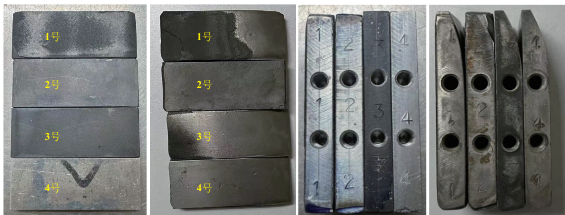
1号—氧化铬等离子喷涂;2号—碳化钨超音速喷涂;3号—离子渗氮;4号—未处理
