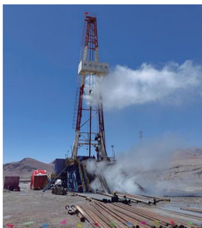
(b)安装防喷导流装置水汽喷射状况
