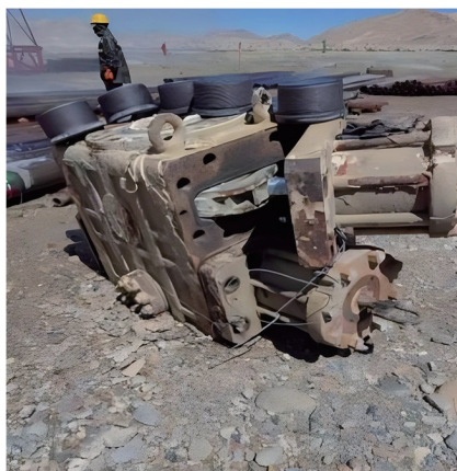
(a)因结垢损坏的防喷器
