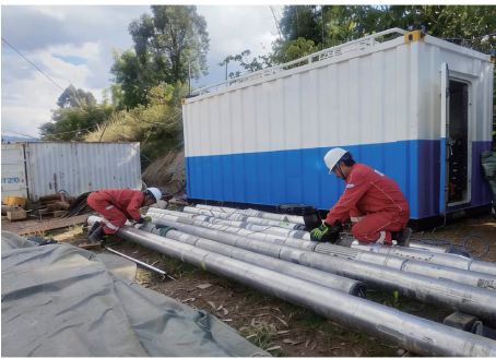
图3 随钻超声成像仪器地面测试
