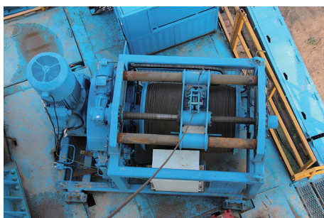
图2 5000 m 电动绳索取心绞车
