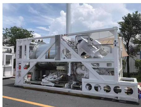
图4 11000 m 电动取心绞车
