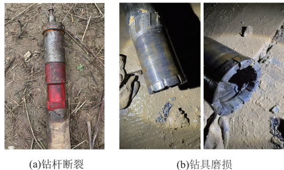
图4 钻具断裂及磨损情况
