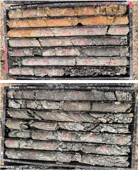
图4 工艺改进后断层岩心
