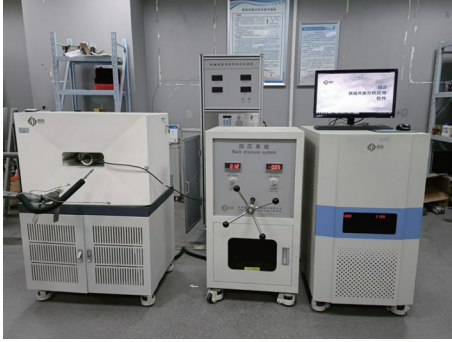
图4 核磁共振岩心分析系统
