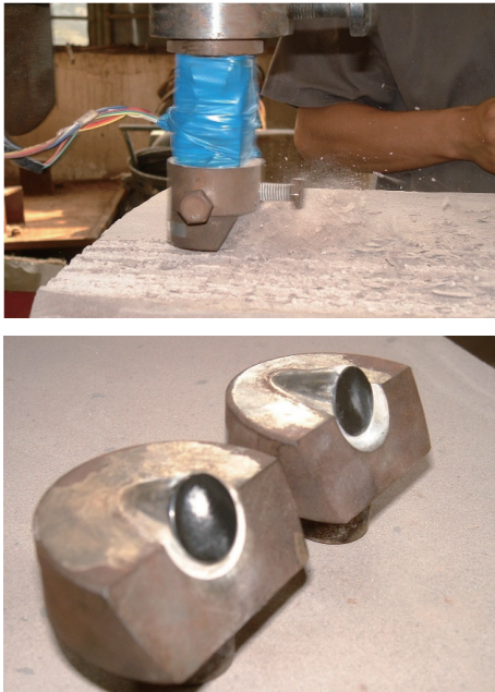
图5 PDC切削齿单齿破岩切削实验
