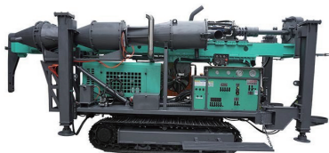
图 2 升级版 JLRC500 型反循环钻机
