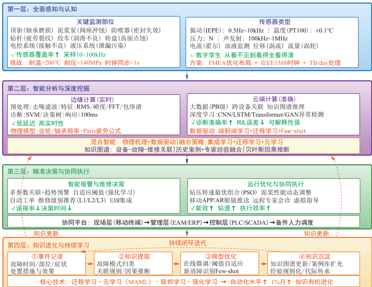
图 3 钻探运维系统核心架构
