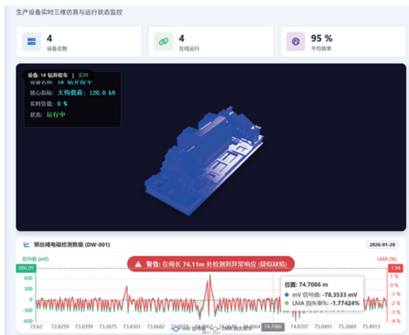
图6 钢丝绳电磁检测在智能运维系统中的应用示例
