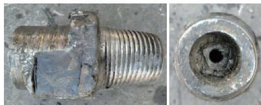
图12 变径接头中折断公锥
