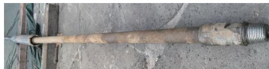
图13 改进的A套铤钻头打捞出钻杆
