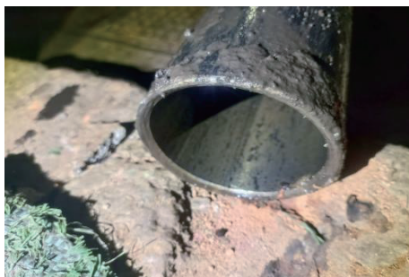
图6 割断的Ø91 mm钻杆
