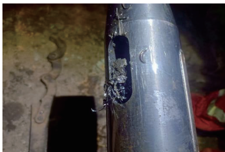
图8 刀刃崩裂并卡滞铁屑
