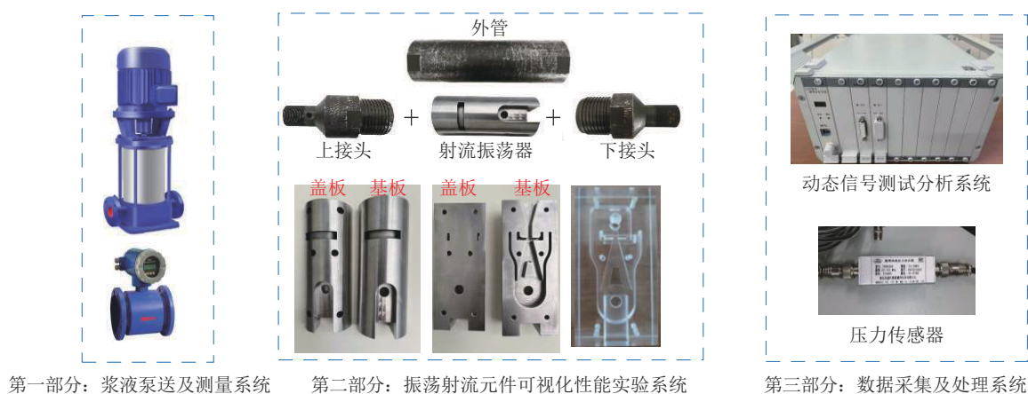
图5 RFOT性能实验示意
