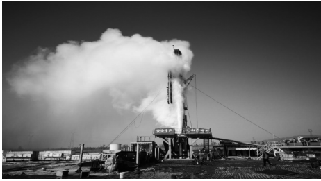
图1 高温高压自喷井现场
