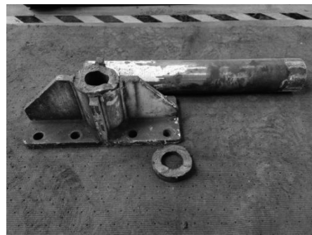
图1 ZDY12000LD型钻机机身立柱断裂失效
