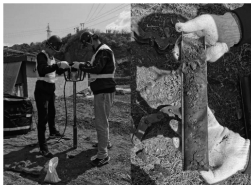
图5 松散层取心效果
