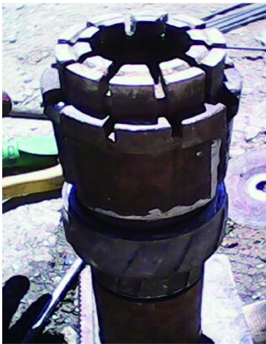
图3 西藏科钻自制增环隙钻头
