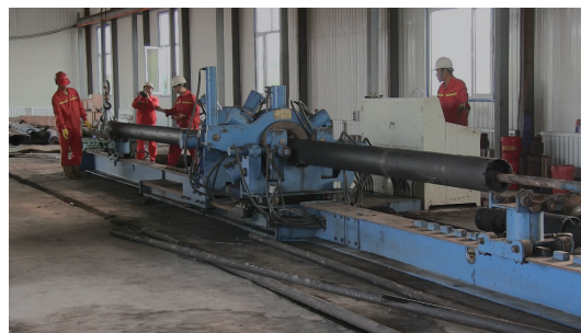
图2 钻具拆装台架辅助机械式岩心出筒
