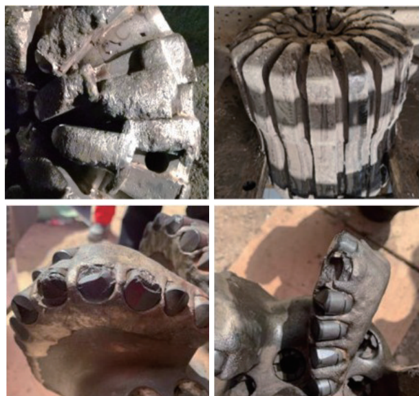
图4 钻井现场PDC钻头磨损情况
