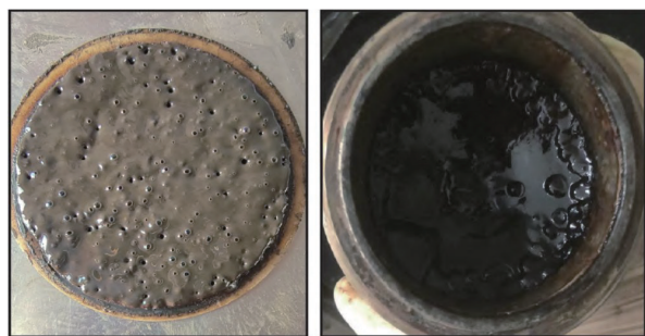
(a)水基钻井液受污染 后泥饼质量变差
