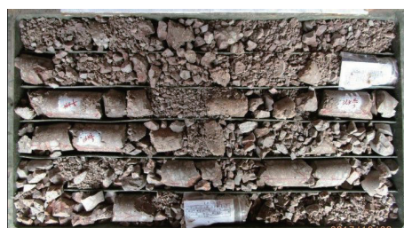
图5 无泵反循环超前侧喷绳索取心钻具所取岩心
