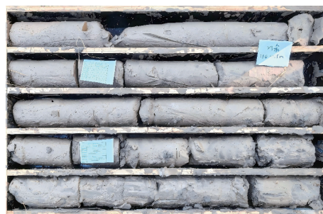
图4 单管钻具在黏土地层取得的岩心
