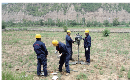
图5 使用TGQ-15钻机采取垂直剖面样品
