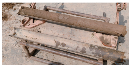
图10 半合管钻具取心效果
