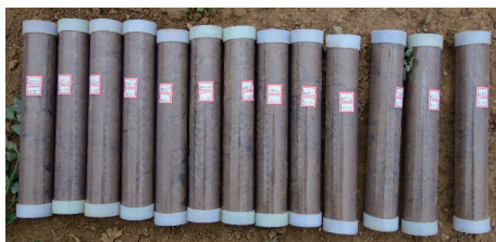
图6 由内置有机玻璃管取出并保存的样品
