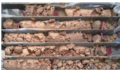
图2 改进的ESD型阶梯型钻头单动双管钻具在卵砾石地层取得的岩心
