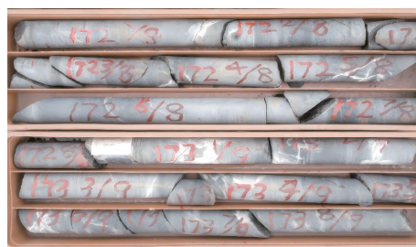
图3 S96金刚石绳索取心钻具取得的岩心
