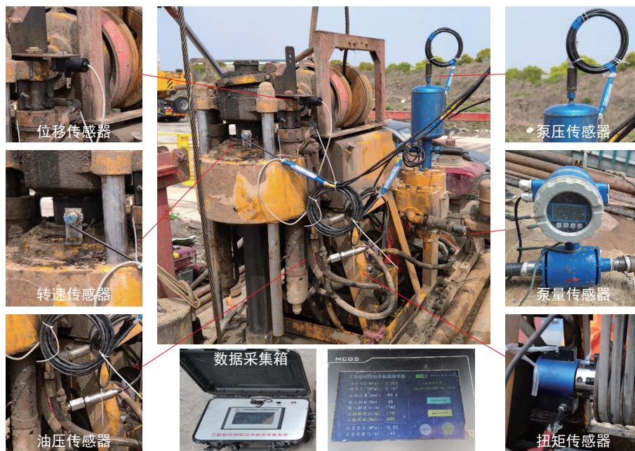
图2 钻机及传感器安装位置
