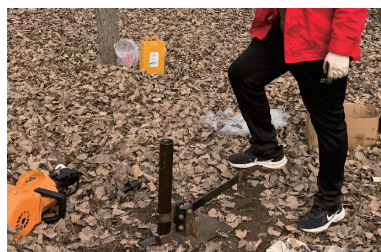
图4 试验过程中使用的护壁钻杆起拔器
