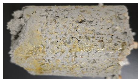
图6 150℃、5 MPa高温高压封闭滤失量测试后的砂床
