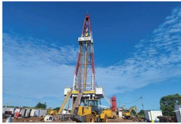
在近3900 m温度超过150℃,达到高温地热标准,在5000 m温度超过180℃,达到国家能源行业标准规定的干热岩温度界限,形成了深层地热资源探测评价关键技术,达到科学探井预期目标和任务要求。
