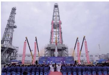
12000 m深智钻机钩载能力高达10000 kN,提升1368根钻柱,实现最大13000 m深度作业;突破了万米管柱“一键联动”自动化等关键技术;配置行业最先进的具有泵健康检查功能的3200HP型五缸泵,泵送超高压大排量;搭载顶尖UNISON2.0控制系统,实现卓越数字化钻井;集成先进视觉识别系统,增强智能感知力,成功实现地面、台面和高空三大区域自动化作业,让钻机能够在超深环境下安全实现“自动驾驶”。
