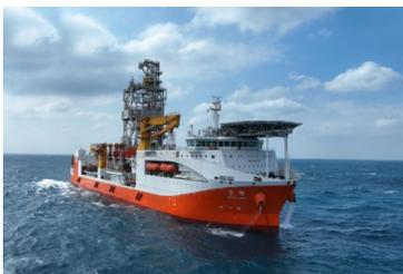
集成大洋科学钻探、深海油气勘探和天然气水合物勘查试采等多种功能。船上建有基础地质、古地磁、无机地球化学、有机地球化学、微生物、海洋科学、天然气水合物、地球物理、钻探技术等9个实验室。配备了全球首套船载岩心自动传输存储系统。
