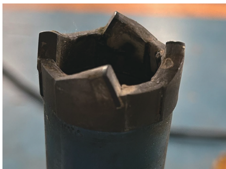
图7 钻进后的PDC取心钻头
