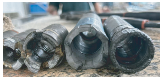
图2 干钻试验钻头
