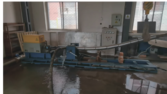
图 8 柔性马达力学性能室内测试
