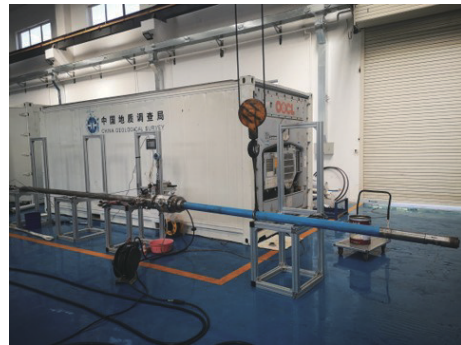
图2 北京探矿工程研究所研发的保压岩心分析及转移系统
