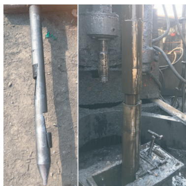
图5 可退式打捞矛及打捞出来的钻杆
