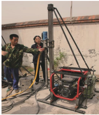
图8 场地钻进试验
