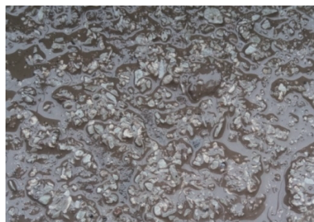
图4 采用 \text{O}136\text{ mm} 钻头钻进排出的直径2~4 mm岩粉
