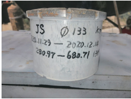
图4 外径加大绳索取心金刚石钻头单只进尺399.74 m
