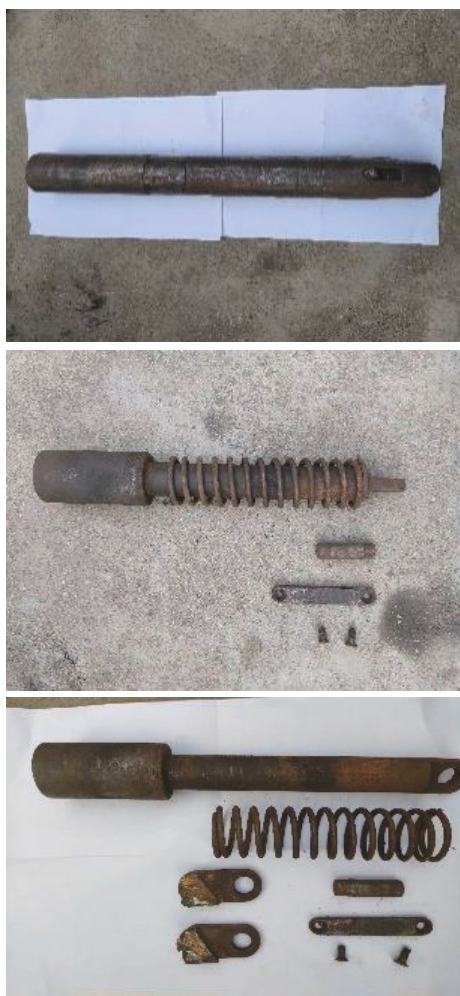
图2 水力割管器实物拆解
