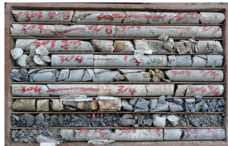
图3 下部破碎带岩心
