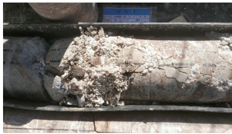
图 3 水敏性蚀变地层岩心
