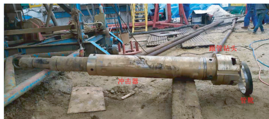
图4 黔水地1井所用跟管钻具 [18]
