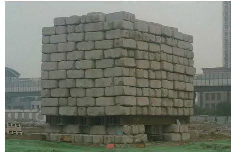
图1 现场堆载试验照片
