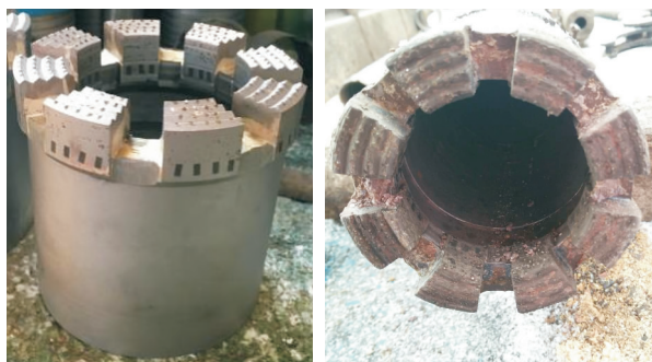
图 9 多级金刚石表孕镶钻头使用前后图片
