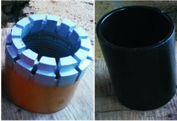
图2 采取煤心用超前底喷钻头和无水口卡簧座
