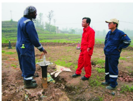
图2 微地震浅井压裂监测现场
