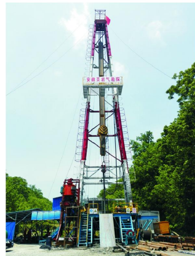
图5 TDQ-3000型变频永磁电动直驱式顶驱钻机
