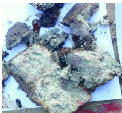
图13 成膜体系浸泡2 h后岩心内部状况
