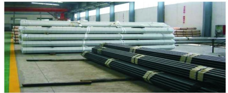
图5 XJY850冷拔无缝钢管
