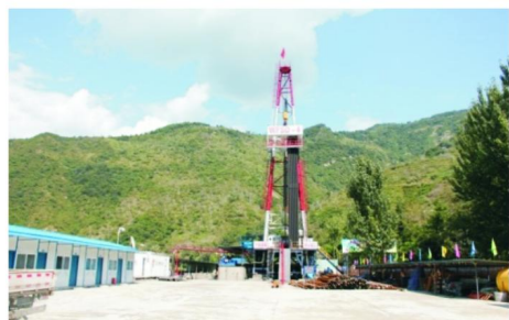
图11 KZ30DB型高转速交流变频顶驱钻机
