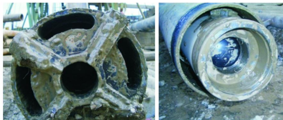
图13 保压取心钻具试验现场及球阀关闭情况
