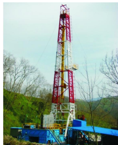
图 9 3000 m 电动直驱顶驱钻机
