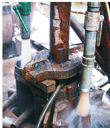
图6 单井抽回两用系统回灌试验
